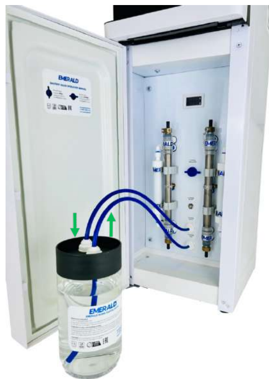
Рис. 13. Образец подключения установки EMERALD в режиме ПРОМЫВКА, этапы ЦИРКУЛЯЦИЯ и ВЫДЕРЖКА.
