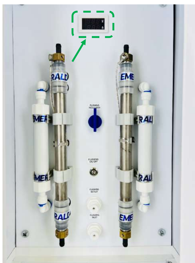
Рис. 11. Электронный индикаторный дисплей с вольтметром (сверху) и амперметром (снизу).
