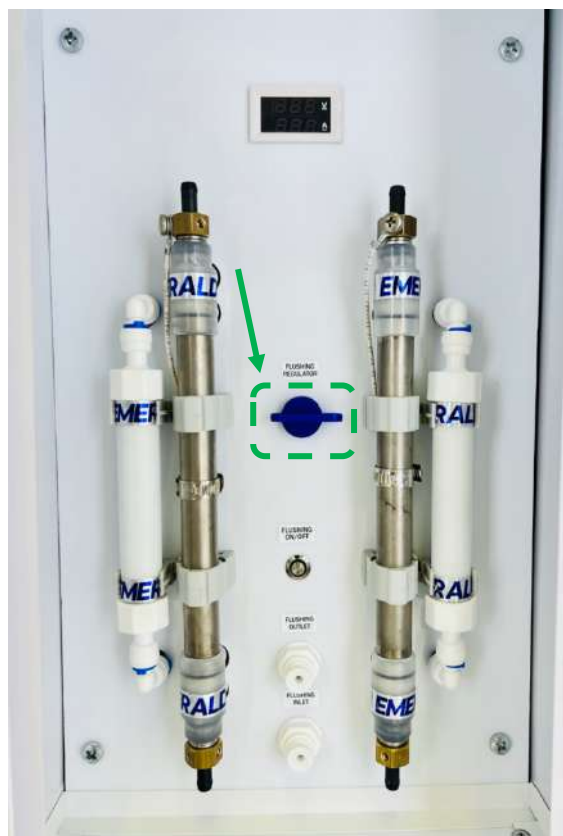
Рис. 12. Кран РЕГУЛЯТОР ПРОМЫВКИ в горизонтальном (закрытом) положении в режиме ПРОМЫВКА.
