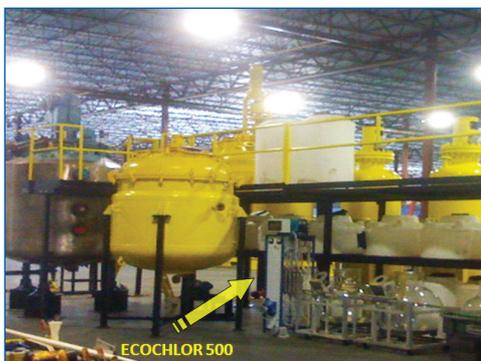
Установка ECOCHLOR 500 используется в Майами (США) для извлечения платины, родия и палладия из отработанных автомобильных катализаторов, позволяя извлекать до 1 кг платины в сутки.
