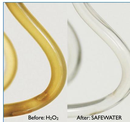
После одного месяца обеззараживания воды раствором оксидантов с концентрацией 0.1 мг/л (вместо перекиси водорода) биопленки были удалены с внутренней поверхности трубки.
