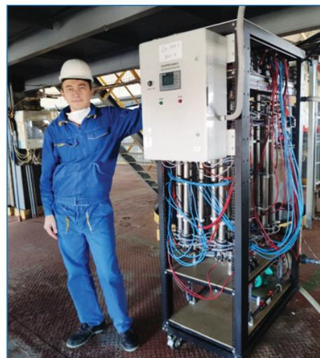
Установка ECOCHLOR 3000 в процессах интенсификации ПСВ урана позволяет увеличить степень извлечения урана с базовых 70% до 96% при использовании ЭХА маточников сорбции, НАК «Казатомпром», Казахстан, 2022 г.
